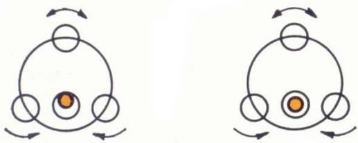
**L'instrument est prêt à être utilisé lorsque la bulle de la nivelle se trouve à l'intérieur du cercle gravé.**
