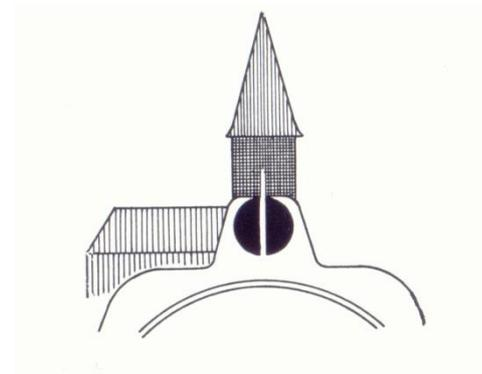
Contrôler le bon fonctionnement du compensateur avant la lecture, au moins à chaque nouvelle mise en place. A cette fin, appuyer sur le bouton de contrôle [9] sous le niveau. Après un bref arrêt des oscillations, la même image doit à nouveau osciller dans sa position de départ.
